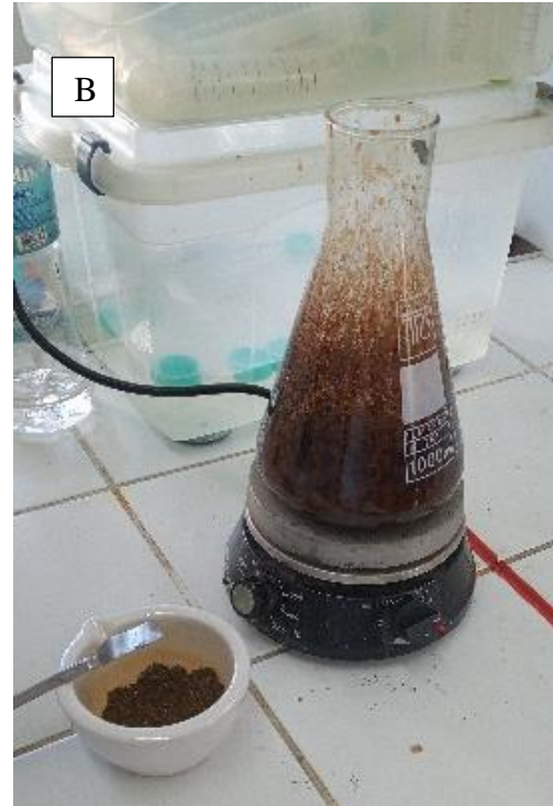
Figura 1- Imagens da síntese do nanocompósito a partir da biomassa do bambu.
